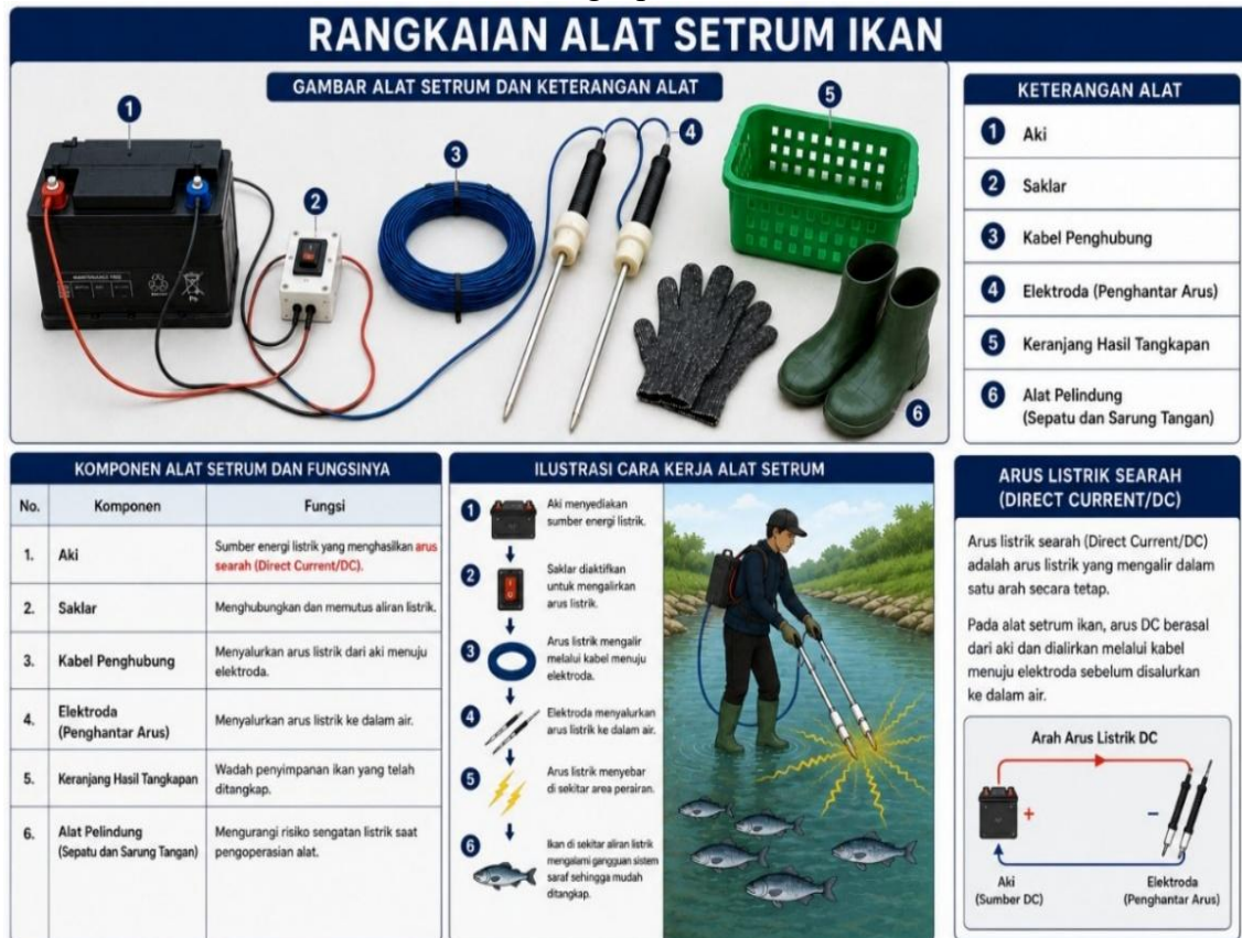
Gambar 1. Rangkaian Peralatan dan Alur Kerja Alat Setrum dalam Praktik Penangkapan Ikan
